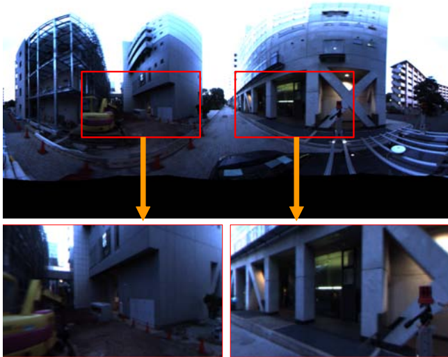
図3 Ladybug2 による全方位画像を透視投影画像に変換した例
